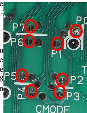
Voici le détail d'un jumper. Il est constitué de 2 zones conductrices. Si ces 2 zones sont reliées par un élément conducteur (par exemple une soudure), on dit que le jumper est fermé. Dans le cas contraire, on dit qu'il est ouvert. Et comme par hasard, le jumper P0 comporte une soudure...
