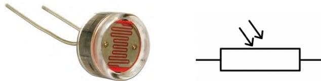
Une photorésistance est un composant électronique dont la valeur de la résistance, en ohms dépend de l'intensité lumineuse qui l'éclaire.
