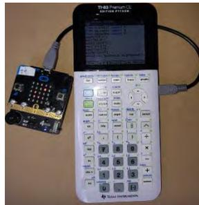
Module **base:bit** permettant l'alimentation de votre carte micro:bit. Ce module comporte également un inverseur marche-arrêt, une led d'indication bleue et un buzzer.
