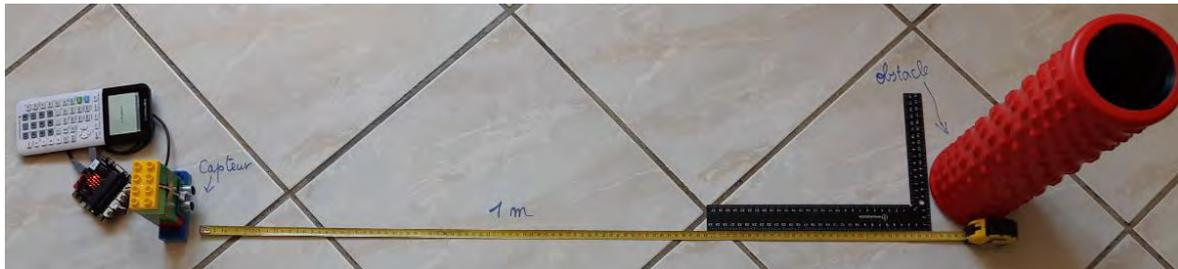
Le script permet d'afficher **la distance mesurée en cm** par le capteur à ultrasons.
