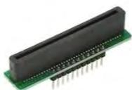
Exemple d'adaptateur de carte micro:bit à une platine de connexions sans soudures.
