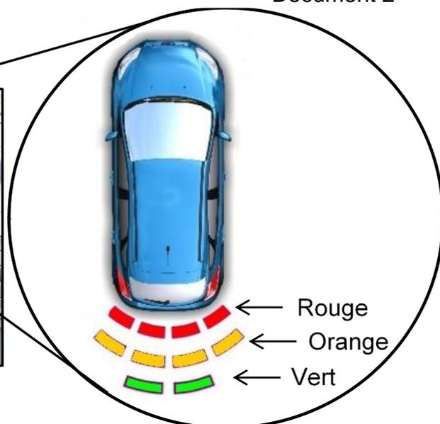
L'affichage au tableau de bord s'active lorsque la distance avec l'obstacle est inférieure ou égale à 2 m. Des voyants verts apparaissent puis oranges, puis rouges au fur et à mesure que le véhicule se rapproche de l'obstacle (*voir Document 3*). Ils sont accompagnés d'un signal sonore émis par un buzzer dont le rythme s'accélère lorsque la distance diminue.
