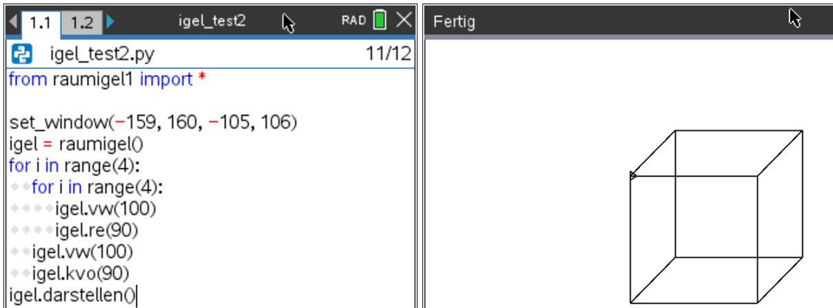
Wir positionieren nun den Würfel zentral im xyz-System und implementieren zwei der leistungsstarken Rotationsmethoden. Wie in einem CAD-Programm kann der Würfel mit den Cursor-Tasten im Raum bewegt werden:
